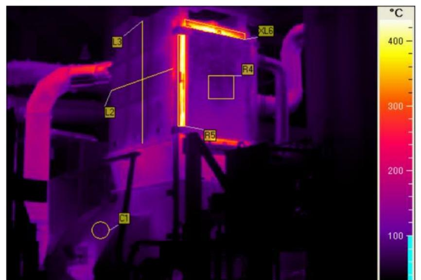
Abb.: Thermografieaufnahme Schachtschmelzofen
