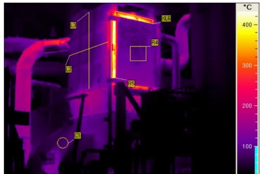
Abb.: Thermografieaufnahme Schachtschmelzofen
