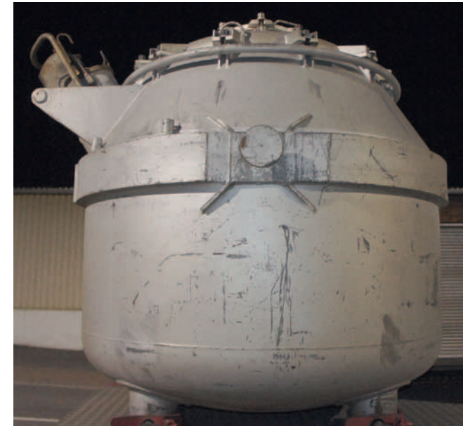
Außenaufnahme eines Transportbehälters für Flüssigaluminium (Foto: DS)
