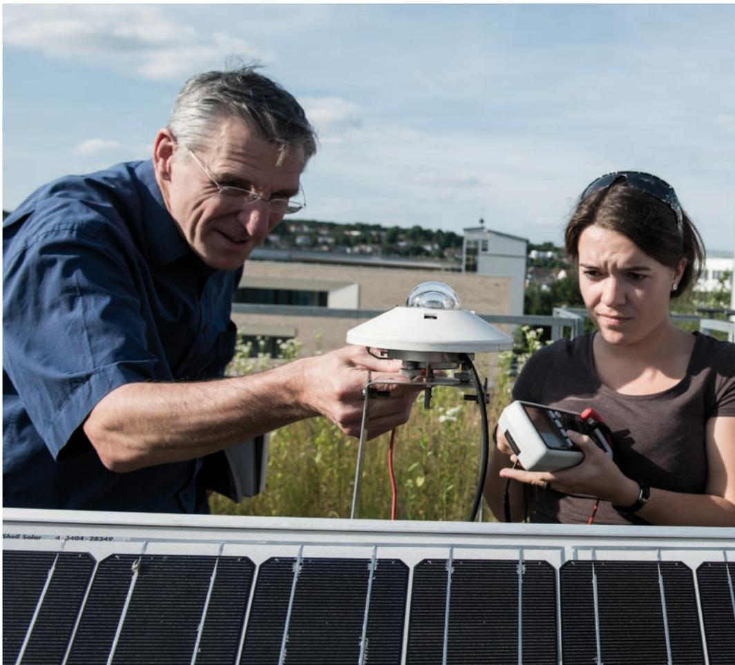
Test eines Pyranometers - das Gerät liefert zeitgenaue Daten über die Strahlung der Sonne, sodass der Wasserstoffherzeuger auf die solare Leistung abgestimmt werden kann
