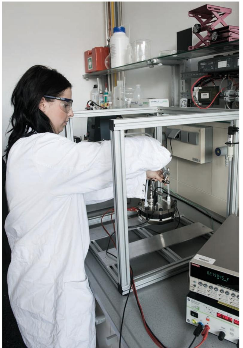
Bild oben: Wasserversorgung für einen Wasserstoff Testelektrolyseur – eine Verbesserung der Entsalzungssysteme reduziert die Kosten in der Wasserstoffproduktion
