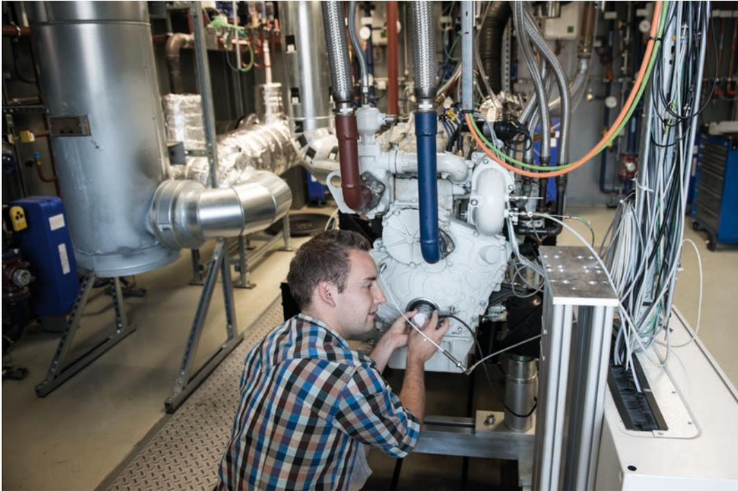
Bild 1: Ein Student installiert den Kurbelwinkelgeber am Gasmotor
