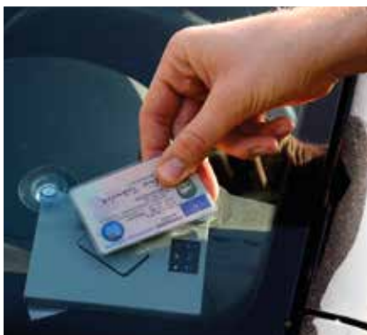
Mit der Marke auf dem Führerschein lassen sich die Türen des Wagens entriegeln.
